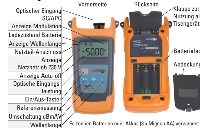
Es können Batterien oder Akkus (3 x Mignon AA) verwendet werden. Die Aufladung der Akkus muss in einem externen Laadegerät vorgenommen werden. Die Dauer des Batteriebetriebes beträgt ca. 140 Stunden.
