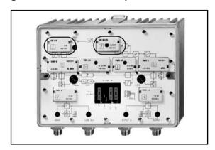
Um das Regelmodul VMC 05 auf Regelmittellage abzugleichen, wird das Einstellglied VMC-E benötigt. Stecken Sie das Einstellglied VMC-E in einen der beiden Entzerrersteckplätze. Stellen Sie nun den Ausgangspegel mit dem Dämpfungssteller rechts neben dem ersten Entzerrersteckplatz auf den gewünschten Wert ein. Einstellglied entfernen und Regelmodul einsetzen.
