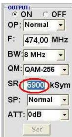
bis 7.200 kiloSymbole/ Sek. Ist vom gewählten QAM-Mode abhängig (in Kabelnetzen übliche Einstellung: 256 QAM / SR 6.900). Es werden nur die Symbolraten akzeptiert die möglich sind.
