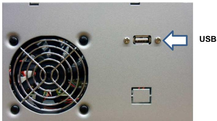
Ist der USB-Zugang von außen nicht erwünscht kann das Verbindungskabel, welches zum Gehäuse führt, abgezogen werden. Das Kabel muss in die Klammer (siehe Bild) gesteckt werden, so dass keine Berührung mit den Leiterplatten oder dem Netzteil möglich ist. Die Programmierung ist somit nur über die interne USB-Schnittstelle möglich.
