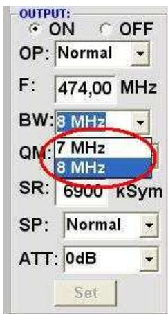
Bandbreite je nach Ausgangsfrequenz zwischen 7 MHz und 8 MHz wählen
