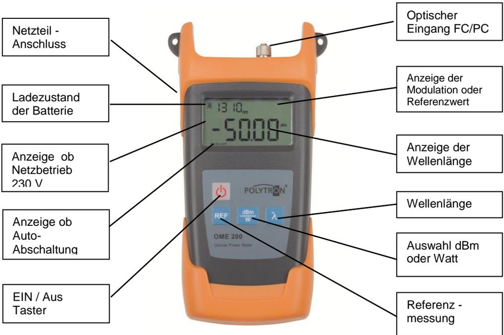
⏻ Ein / Aus – Taster: Dient zum Ein – bzw. Ausschalten des Gerätes. Bei ausgeschaltetem Gerät wird durch einfaches Drücken des Tasters das Gerät eingeschaltet. Ist das Gerät in Betrieb muss der Taster zum Ausschalten ca. 1 Sekunden gehalten werden, Die Auto-Off Funktion ist standardmäßig eingeschaltet, zu erkennen an dem Schriftzug „Auto-off“. Somit schaltet sich das OME 200 automatisch nach ca. 10 Minuten aus. Um dies zu deaktivieren genügt ein kurzer Tastendruck auf ⏻.
